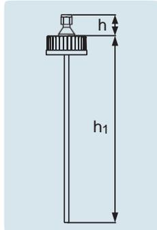
Le support pour sonde de température pour le capuchon à visser DURAN® GL 45 est composé d'un support en acier inox solidement intégré dans un capuchon GL 45 bleu en polypropylène. Le support est destiné aux sondes de température en métal de 6 mm de diamètre. Lors de l'autoclavage ou de la stérilisation, la température de stérilisation est mesurée à l'aide d'une sonde de température en métal.
